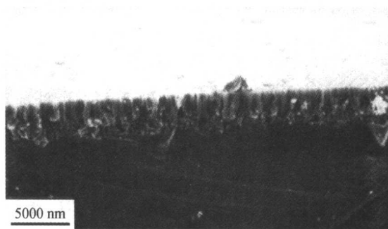
图 1-7 Si 单晶基底上直立生长的 Si 纳米线的横截面图
