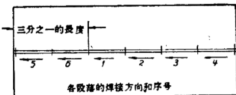
圖 6 实行点焊固着長焊縫的焊接示意图。
