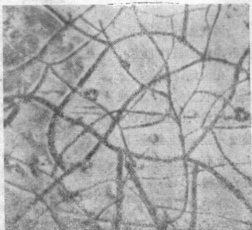
圖9 混合型(溝狀及點狀)的多孔性鉻鍍積物。
