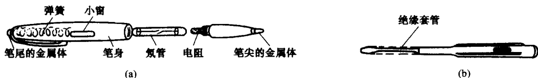
图 1-1 低压验电器 (a) 钢笔式低压验电器 (b) 螺丝刀式低压验电器
