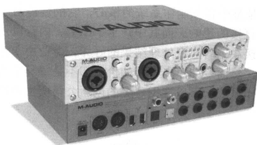
图 1-7 M-Audio FW410 外置火线声卡
