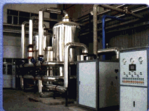
◀KDN-1600/70Y 型高纯氧设备预冷机组和纯化器系统及机旁仪控柜
