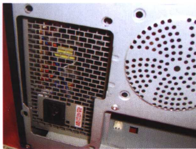
图2 将电源螺丝孔和机箱螺丝孔对齐
