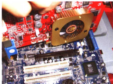
图 21 将显卡插在AGP插槽
