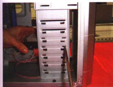
图 31 用螺丝钉固定硬盘
