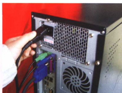
图 47 机箱电源线的连接
