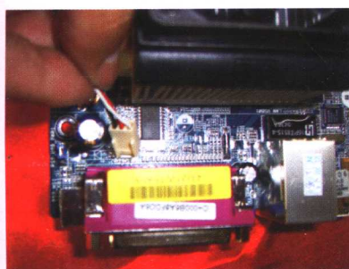
图10 安装CPU散热器电源线
