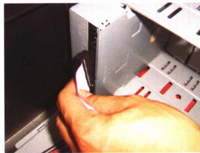
图 32 光驱数据线的连接
