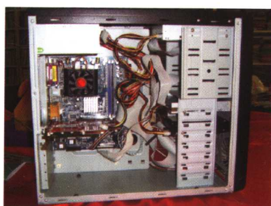
图 41 整理机箱内部连线
