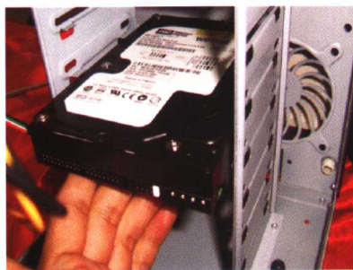
图 29 将硬盘平放入托架
