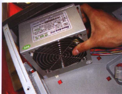
图1 将电源放入机箱的电源固定位
