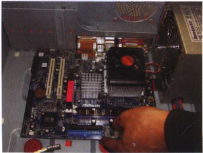
图 15 将主板倾斜放入机箱中
