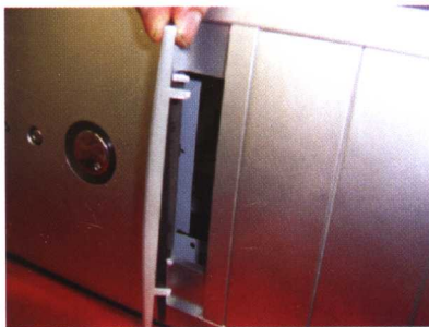
图 26 撬开机箱软驱挡板
