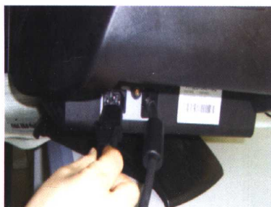
图 46 显示器电源线的连接
