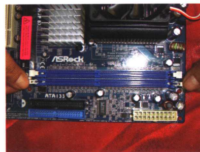
图11 掰开内存插槽两端的卡子
