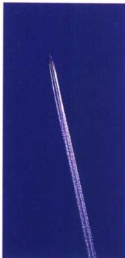
一架喷气式飞机加速飞越大气层，后面留下一道明显的痕迹，叫雾化尾迹，俗称拉烟。拉烟是由水蒸气在发动机的废气中沉淀，凝结成细小的冰晶而形成的。
