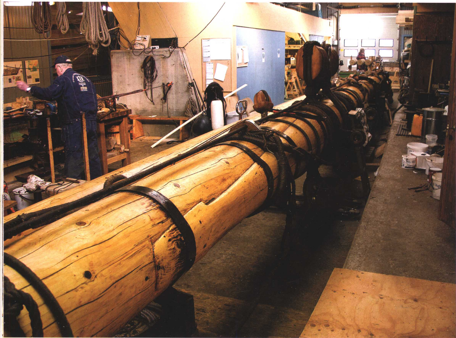
主帆桁和前帆桁由两根云杉拼成，末端紧紧锲合在一起。
