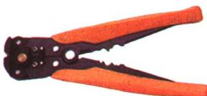
压线钳有手力压线钳、杠杆式压线钳、液压压线钳等。用于不同截面的导线与接线端子的压接。
