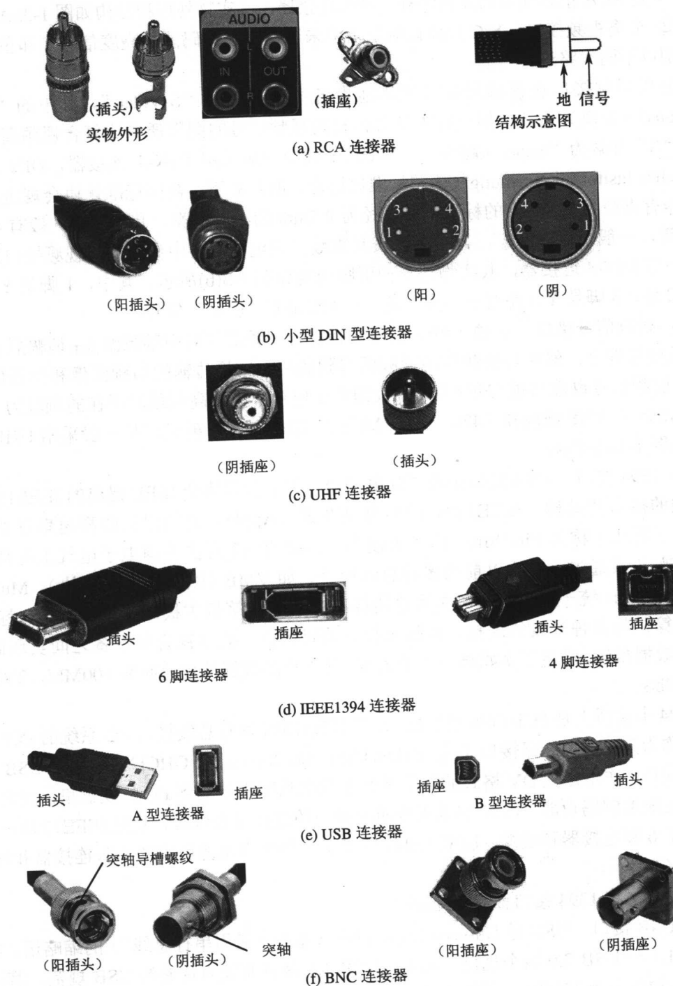
图 1-3 各类信号接口采用的连接器
