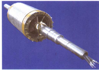
彩图 14 三相异步电机的笼型转子(铸铝)和绕线转子(未装集电环时)
