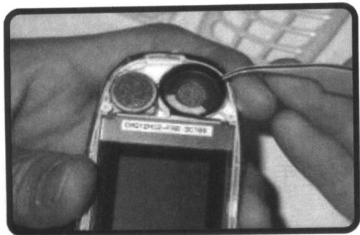
图 1-1-15 用镊子小心地取下振动电动机、受话喇叭 (二)
