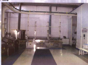
CDG-2500 型 隔板自动退磁机
