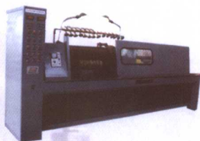
CDG-6000 型 弹簧半自动磁粉探伤机
