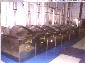
YGST-1200 型半自动荧光渗透检测流水线
