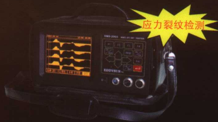
▲ EMS-2003 智能便携式磁记忆涡流检测仪（已用于总装备部某研究所）
