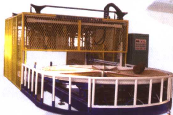
CDG-2500 型 隔板自动退磁机
