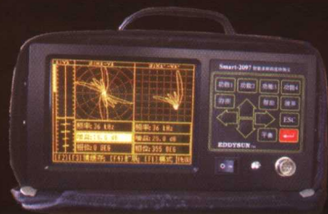
▲ SMART-2097 智能多频涡流探伤仪（电力行业焊缝无损检测标准指定实验用仪器）
