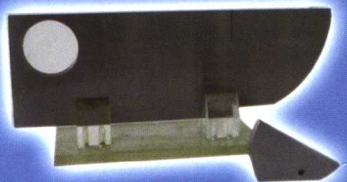
IIW1 (V-1) 试块及支架 IIW2 (V-2) 试块
