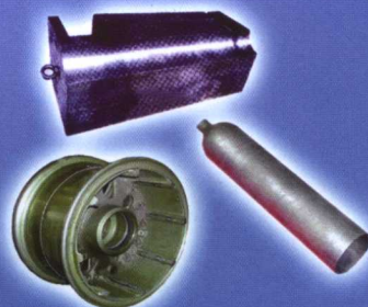
核电站、飞机轮箱、消防桶 超声检测对比试块
