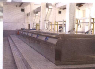
YGST-1500 型 半自动荧光渗透检测流水线
