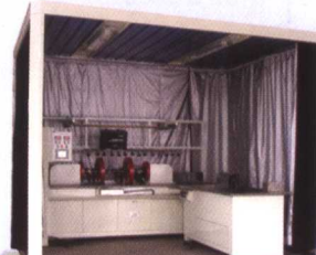
CDG-3000 型 凸轮轴半自动荧光磁粉探伤机
