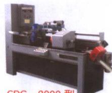
CDG-2000 型 螺栓半自动磁粉探伤机
