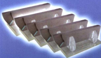
DL/T820-2002 中、小径管焊接接头专用试块
