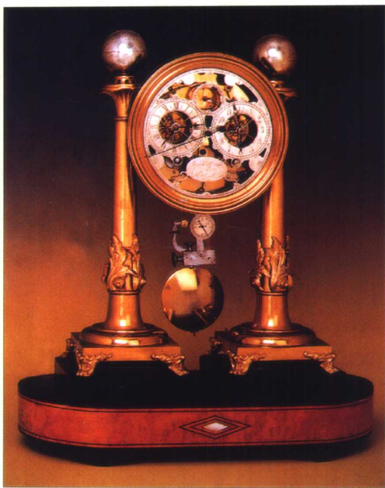
1840年由蒂尔的范·斯潘捷制造的摆钟（高49cm，宽42.5cm）。此钟有两个钟面，分别显示当地时间和太阳时间。接近顶端的小针，每秒内动两次；中间的秒针是一大针，每秒动一次。钟面下的补偿摆是范·斯潘捷本人研制的。
