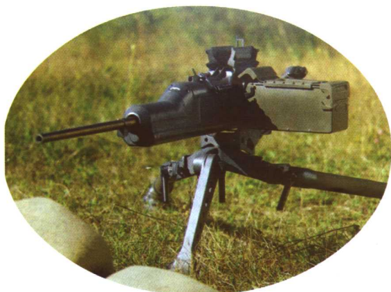
美国XM312 12.7毫米大口径机枪，射程超过2000米。5分钟即可转换成XM307 25毫米榴弹发射器
