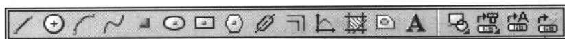
直线 圆 圆弧 样条 点 椭圆 矩形 正多边形 中心线 等距线 公式曲线 剖面线 填充 文字 块生成 提取图幅 技术要求库 构件库
