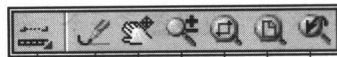
两点距离 重画 动态显示平移 动态显示缩放 显示窗口 显示全部 显示回溯
