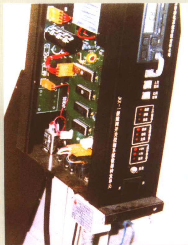
研制的站场接触网开关 微机集中监控装置
