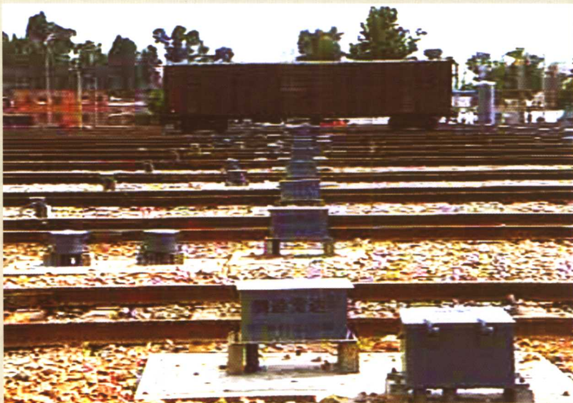
昆明东站采用第四代综合自动化驼峰系统
