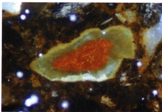
图2.11 在还原不足的情况下,用光学显微镜看到的团块的矿相照片 II
