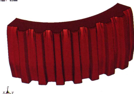
图 10.8 低齿预成形坯锻后形状
