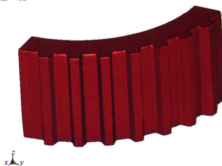
图 10.9 高齿预成形坯锻后形状图
