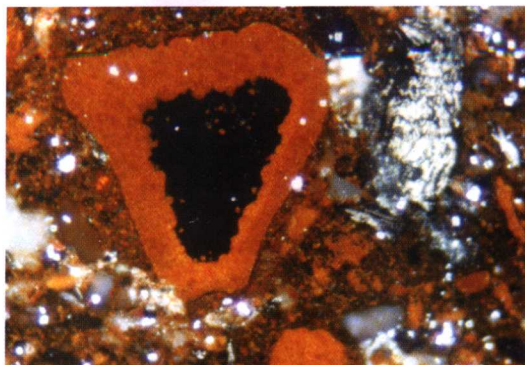
图2.10 在还原不足的情况下,用光学显微镜看到的团块的矿相照片 I
