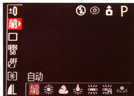
▲ 这是一台家用数码相机的白平衡设置，可以适应不同的色温
