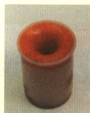
图11.1-5 液态的蜡在 凝固时体积 缩小，中间 凹陷下去。
