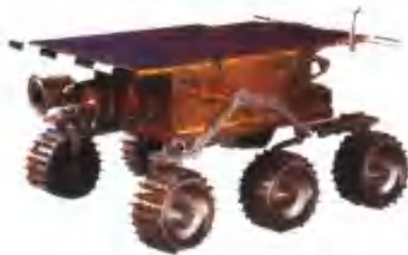
(c) 火星探测车的轮子很宽大
