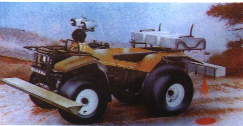
可扫地下 30 厘米深非金属雷的美国遥控扫雷车
