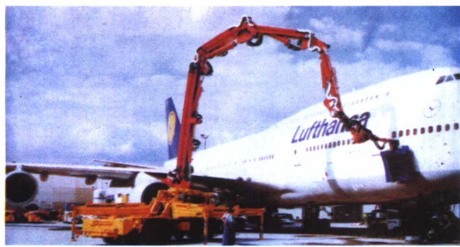
↓ 飞机清洗机器人 “清洗巨人”
