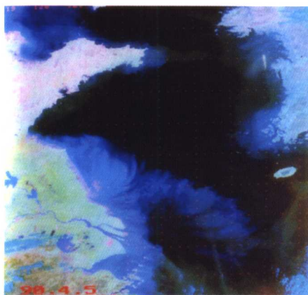
彩图19 气象卫星第4、第2、第1波段真假彩色合成图 (1990年4月5日北京时间13点53分)。图中羽状浅色调影像是海洋浮游生物富集海域, 此区域对应上图海面温度水平变化较大的区域 (海洋峰面)
