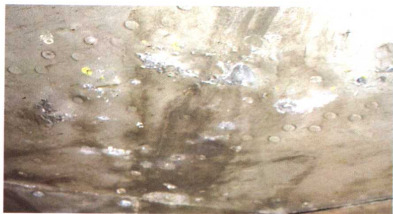
附图1 JX 机翼下表面严重剥蚀
