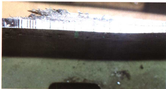
(b) 典型腐蚀部位断口照片
