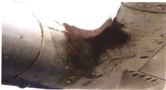
(a) 平尾配重连接部位严重腐蚀
