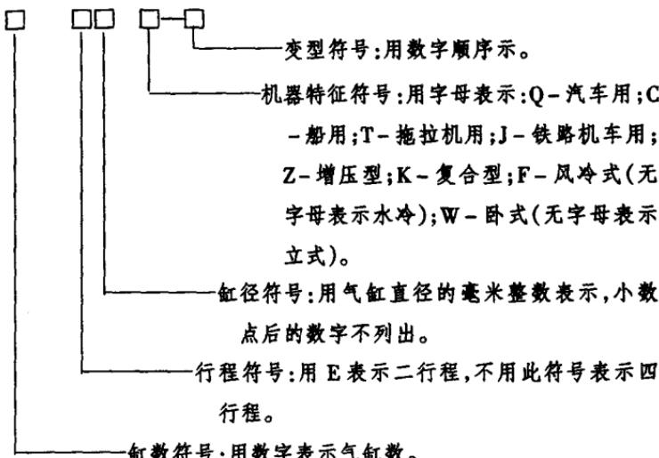
如:195W-1 型柴油机表示,单缸、四行程、缸径 95 毫米、水冷、卧式柴油机、第 1 次变型产品;165F 型柴油机表示:单缸、四行程、缸径 65 毫米、风冷、立式柴油机;1E50F 型汽油机表示:单缸、二行程、缸径 50 毫米、风冷、立式汽油机;4115T 型柴油机表示:4 缸、四行程、缸径 115 毫米、水冷、拖拉机用立式柴油机。
