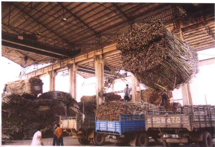
云新公司日榨 2000 吨甘蔗压榨车间
