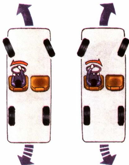
方向盘的转动与汽车行进方向的关系
