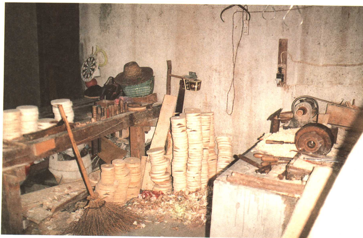
老吴鲁衡罗经店罗经制作工序之一，罗经盘手坯制作
