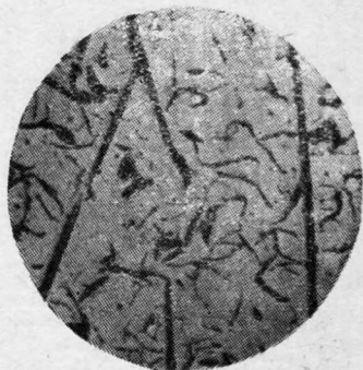
圖1. 灰口鑄鐵中之初晶石墨分布情況。100倍。未侵蝕。粗大黑長條為初晶石墨，短條為共晶石墨。
