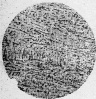
图6. 共晶白口铁显微组织。500倍。由冷激凝固而产生，这是一种高温时渗碳体与奥氏体的共晶体（莱氏体）。
