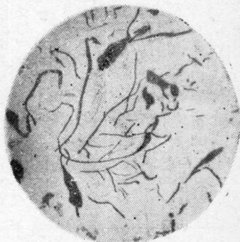
图15. 散乱弯曲分布的石墨。放大 100 倍。未侵蚀。
