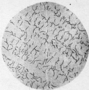
圖12. 有方向性偏析集狀分布的石 墨。放大100倍。未侵蝕。
