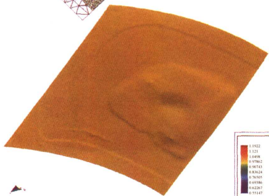
彩图 2 汽车门的金属成形非线性分析
