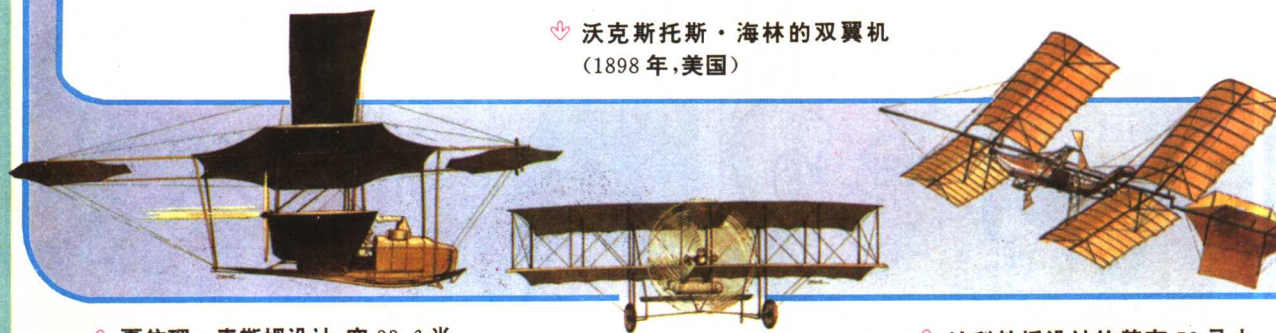
↑ 兰利教授设计的装有52马力的汽油发动机的实验飞机(1903年,美国)
