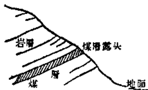
第一圖 在煤層出露,斜度較緩,岩層較硬時,可沿煤層露頭打井
