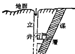
第四圖 煤层如傾斜很陡可用立 井和石门来开拓
