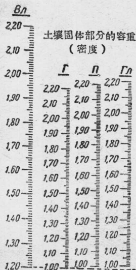
圖 2 密度-湿度仪（第一种方案）浮子管子上的标尺
