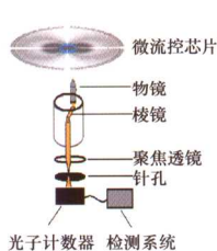
阵列化学发光(CL)检测原理(左)及样机(右)
