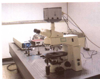
单分子检测装置（左），微通道中不同浓度的 \lambda DNA分子（右）
