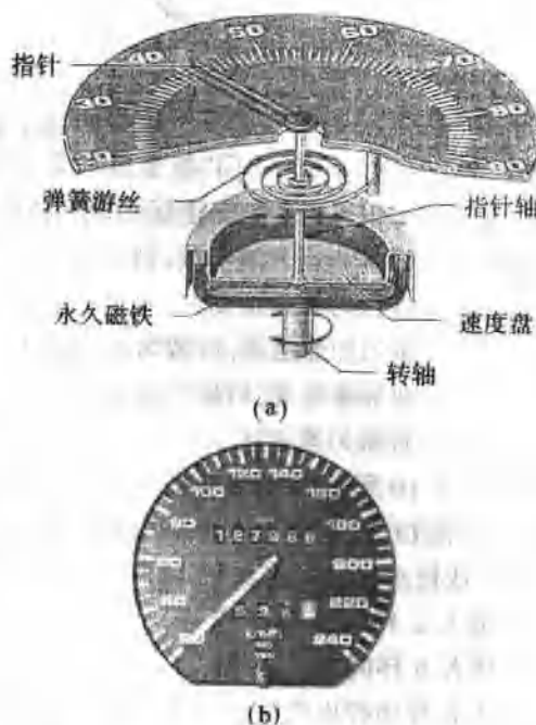
图 4-4-13 汽车速度计的结构示意图
