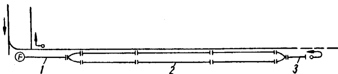
图2 单机压入大直径双风筒布置方式
