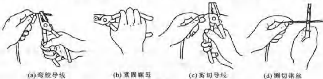
图 1-9 钢丝钳使用方法示意图
