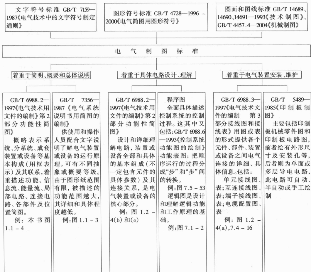
图 1.2-1 几种电气图的特点和应用场合
