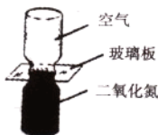
抽去玻璃板后,两瓶中的气体逐渐混合
