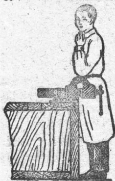
图 1.1-4 确定虎钳高度的方法
