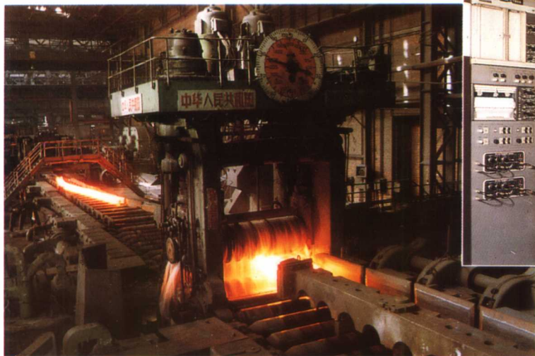
鞍山钢铁(集团)公司第二初轧厂 1150 初轧机轧制钢锭
