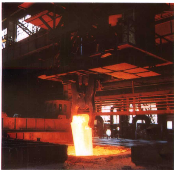
鞍山钢铁(集团)公司第二初轧厂钢锭均热后出炉
