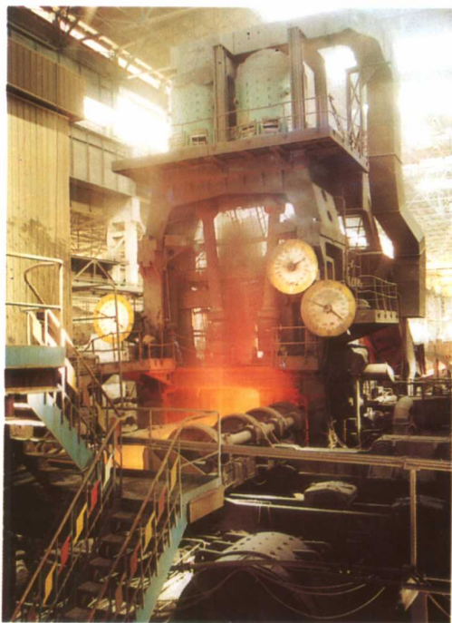
本溪钢铁(集团)有限责任公司初轧厂 1150 万能板坯初轧机液芯轧制沸腾钢板坯
