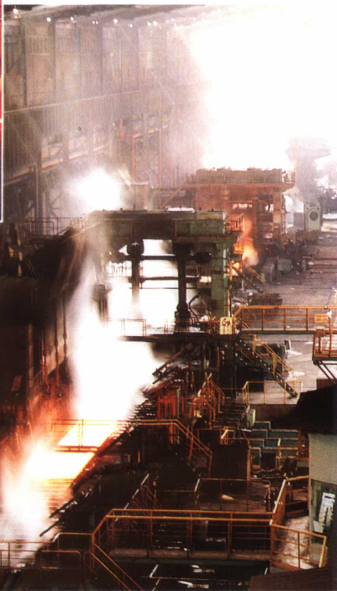
武汉钢铁(集团)公司热轧厂 1700 热轧宽带钢轧机精轧机组
