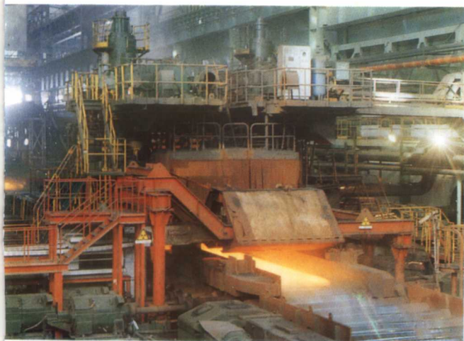
鞍山钢铁(集团)公司厚板厂 4300 轧机轧制宽厚钢板
