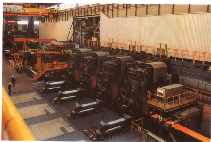
德国曼内斯曼—德马克(MDH)公司长仅 180m 的薄板坯连铸连轧生产线
