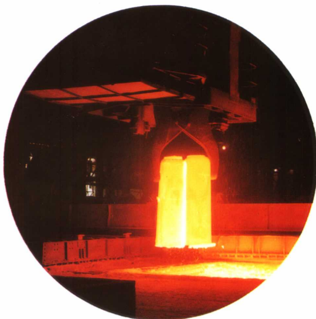
鞍山钢铁(集团)公司第二初轧厂均热炉热装钢锭
