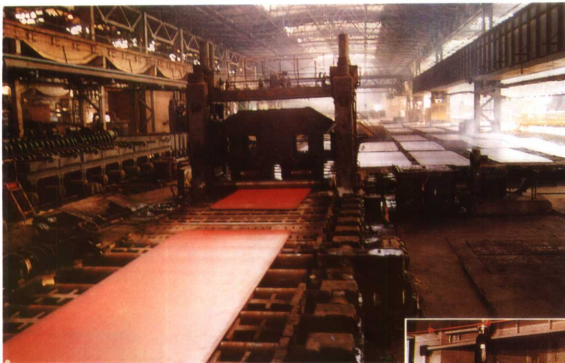
邯钢集团舞阳钢铁公司九辊热矫直机矫直厚板
