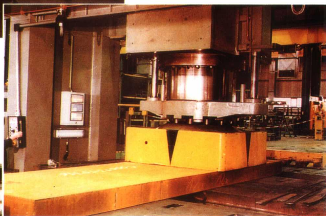
邯钢集团舞阳钢铁公司 25000kN 液压矫直机矫直钢板
