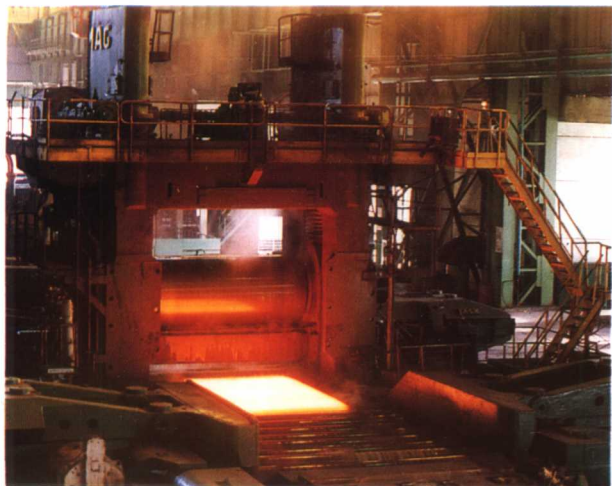
上海浦东钢铁(集团)有限公司厚板分厂 3300 轧机轧制 20mm 锅炉钢板
