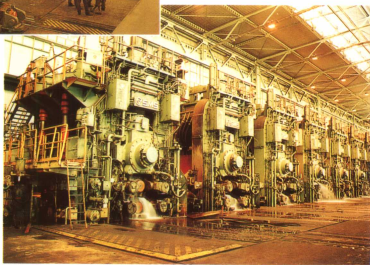
宝山钢铁(集团)公司热轧带钢 厂 2050 热连轧机 7 机架精轧机组
