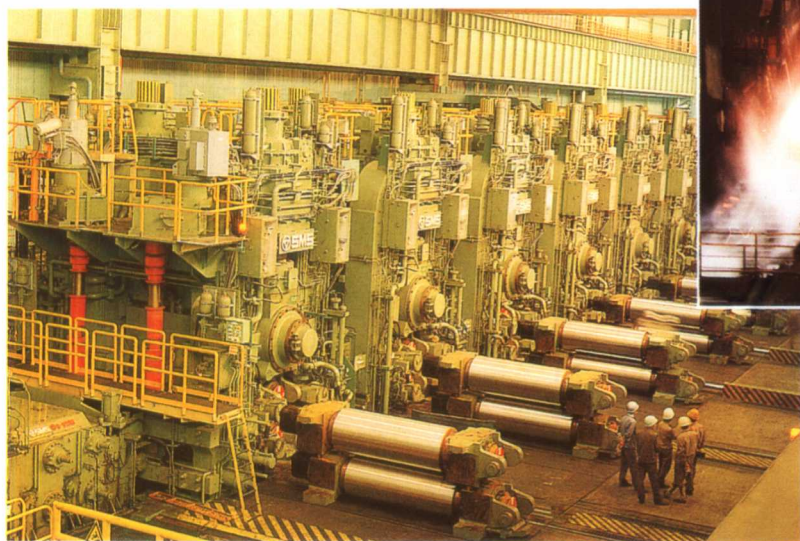
宝山钢铁(集团)公司热轧带钢厂采 用串列横移式小车更换精轧机组工作辊
