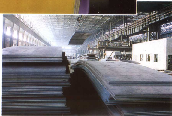
武汉钢铁(集团)公司轧板厂 生产的 4C(D 级)造船用厚钢板
