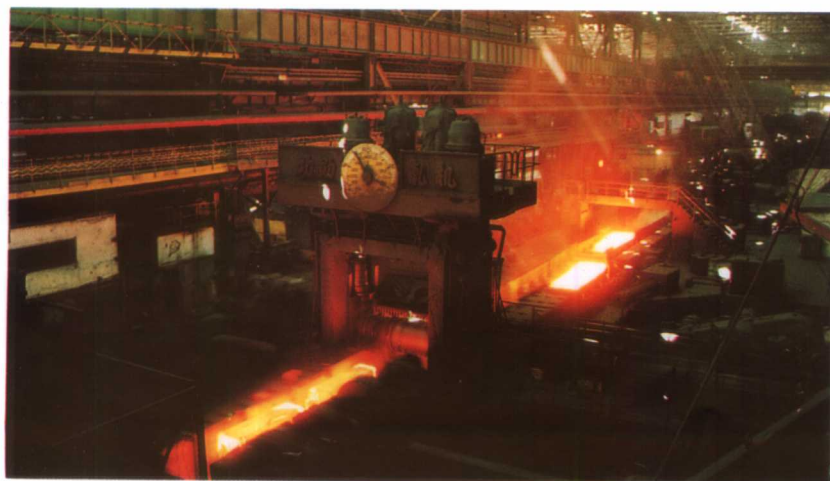
鞍山钢铁(集团)公司第二初轧厂 1150 初轧机双锭轧制
