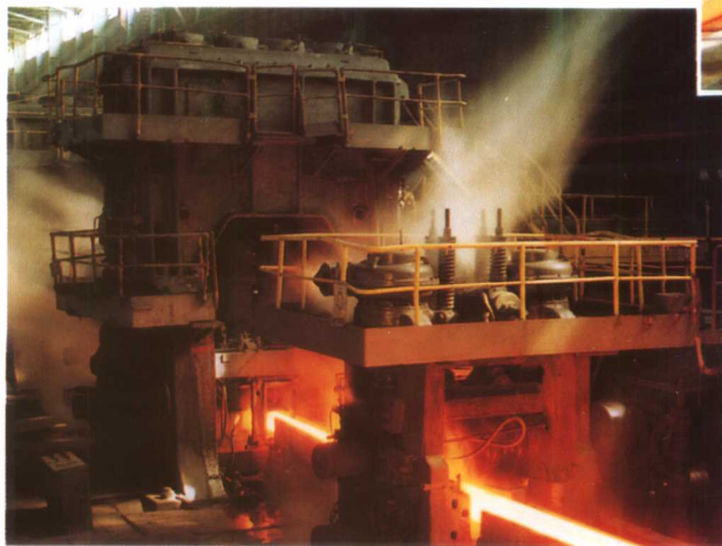
本溪钢铁(集团)有限责任公司初轧厂 1150 万能板坯初轧机液芯轧制沸腾钢板坯
