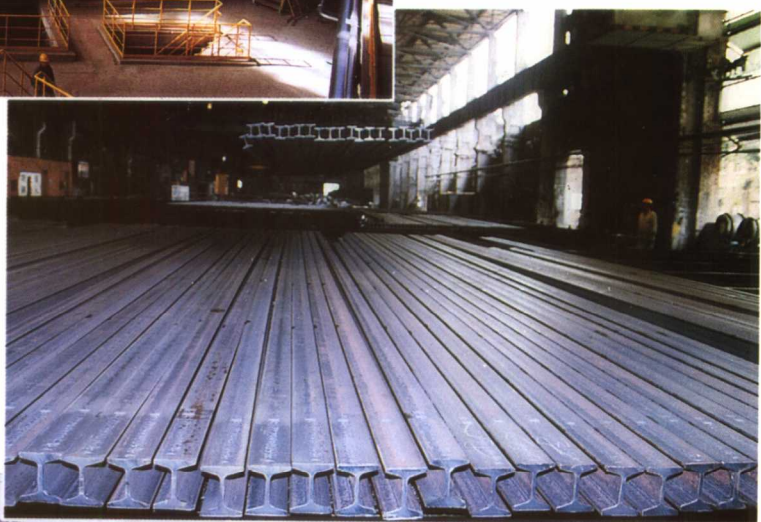
武汉钢铁(集团)公司大型厂 生产的大型工字钢
