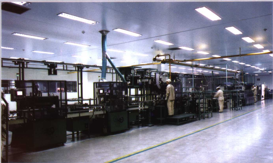
广州电池厂引进的LR6无汞碱性电池生产线（2000年）。
