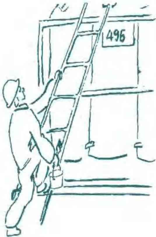
1. ××年3月19日，××供电局35kV××变电站停电进行春检。其中35kV××线496断路器清扫、刷漆，其线路侧隔离开关496-1带电。
