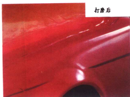
图3-3-16 打磨标志涂料后的外观
