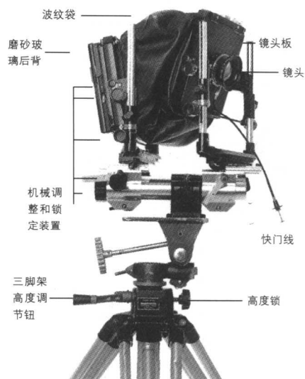
我的 Toyo 45g 4in × 5in (10cm × 13cm) 观察照相机，它经常会被损坏和修理。相机上装有波纹袋和机械装置。
