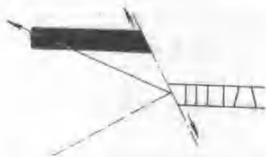
图 1-5 打钻探明断失煤层 示意剖面图
