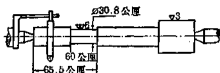
圖 3-3 改進后第三道工序示意圖
