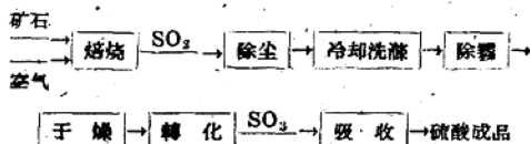
图 1 接触法硫酸生产流程
