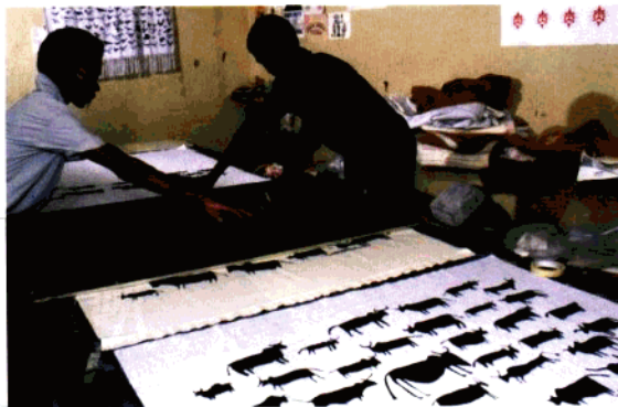
△丝网印刷中，橡胶铲使油墨透过模板印刷到绷紧的丝绸纤维上。这种简单的低成本印刷不需要印刷机，就可以将图案像印在纸上那样很容易地印到纤维或金属上。
